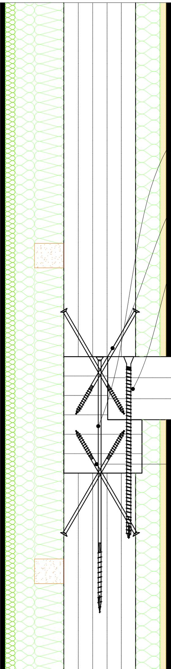
Vite di posizionamento banchine sulla pareti BBS
